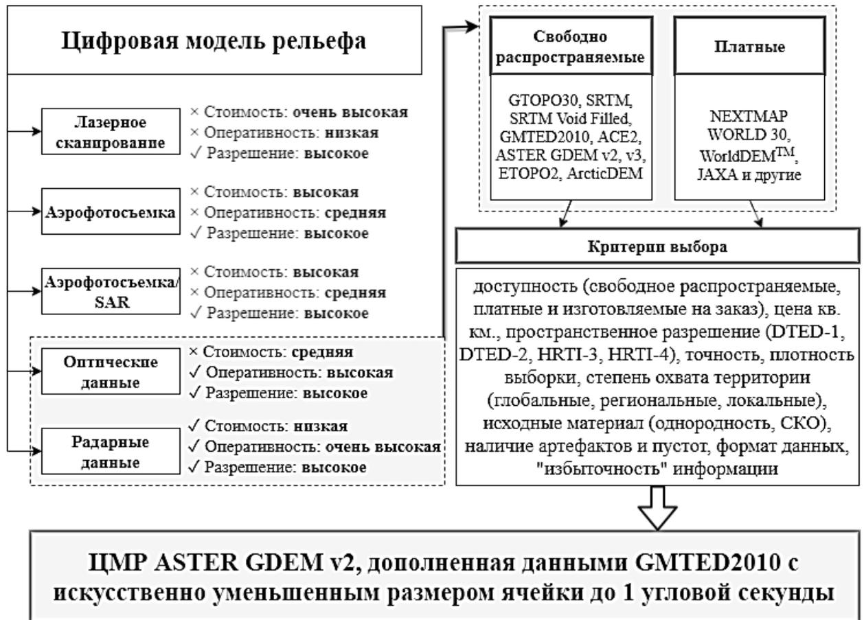
Рис. 1. Упрощенный алгоритм выбора цифровой модели рельефа
