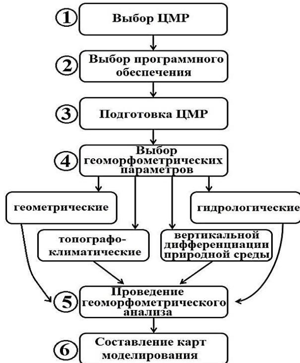
Рис. 1. Блок-схема методики проведения геоэкологических исследований на основе цифрового моделирования рельефа, по (Полякова, 2018)
